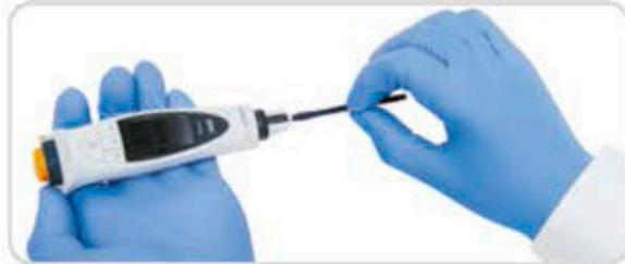
3. Открутите поршень дозатора против часовой стрелки.
