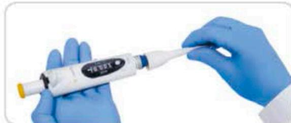
1. Открутите сбрасыватель на кончике дозатора против часовой стрелки и снимите его.
