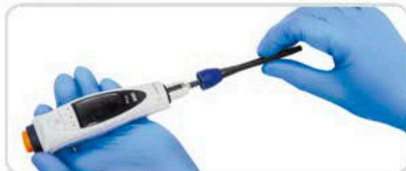
2. Открутите держатель посадочного конуса против часовой стрелки и осторожно снимите его вместе с конусом. Удалите защитный фильтр Safe-Sope, если он был установлен.
