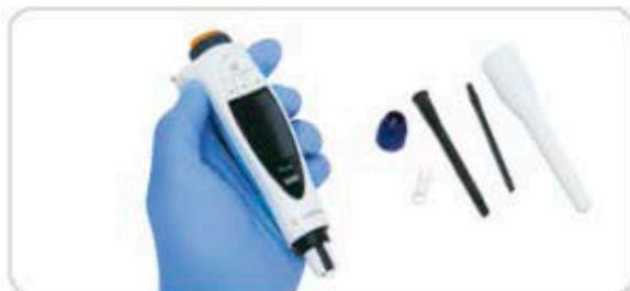
4. Поместите конус, держатель конуса, сбрасыватель на кончике, поршень и пружину в чашу, заполненную 70% раствором этанола, и оставьте, как минимум, на 30 минут.
