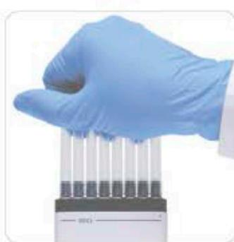
Механизм OptiLoad обеспечивает плотное прилегание и герметичность присоединения наконечников
