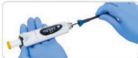
2. Открутите держатель конуса на конце дозатора против часовой стрелки и осторожно снимите его вместе с посадочным конусом. Снимите защитный фильтр Safe-Sope, если он был установлен.
