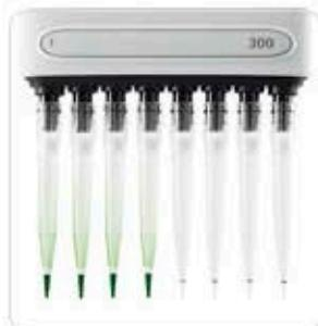
Четыре наконечника справа — наконечники Low Retention, обеспечивающие максимальную сохранность образца.
