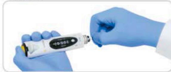
3. Открутите поршень дозатора против часовой стрелки.
