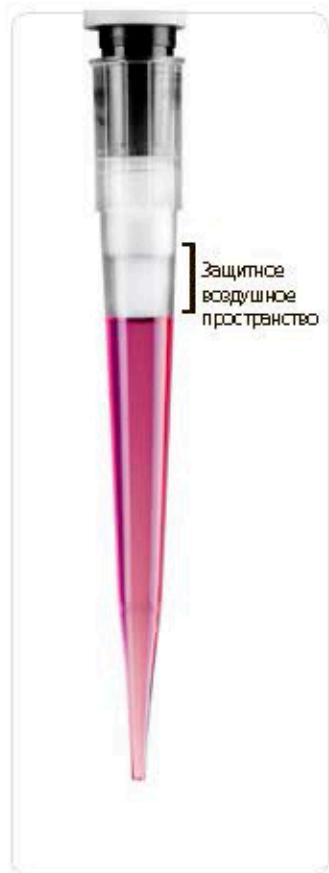
Наконечники с фильтрами изготовлены из первичного полипропилена и снабжены барьерными фильтрами, которые эффективно задерживают частицы аэрозолей и жидкостей. Во избежание проникновения образца в фильтр и последующего влияния на результат сами фильтры изготовлены из полипропилена без использования «самоуплотняющихся» добавок. Фильтр защищает образец от контаминации. Также он защищает дозатор и увеличивает интервалы между техническим обтукиванием дозатора.
